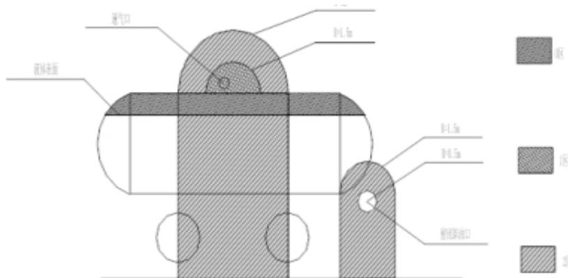
图 3-2 油罐车卸油爆炸危险区域划分
