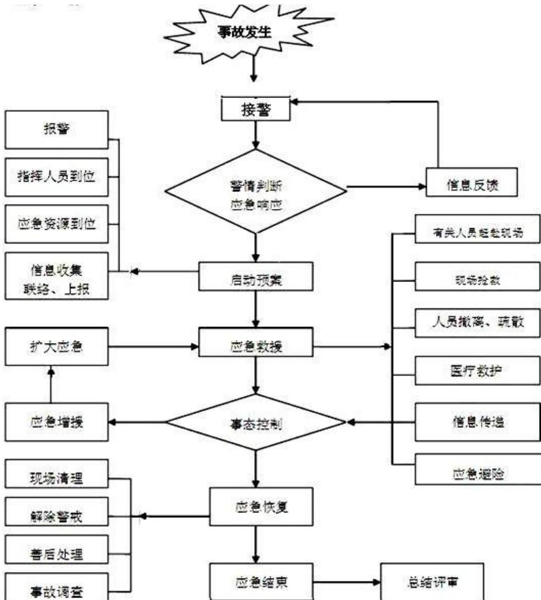
图 5-2 一级应急响应程序图
