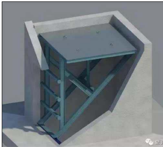
电梯井移动式铁平台
