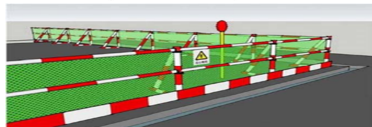
基坑临边安全防护立面图
