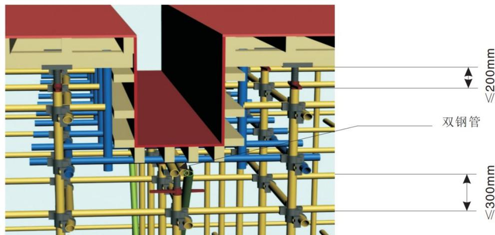
钢管扣件式支撑架设置示意图
